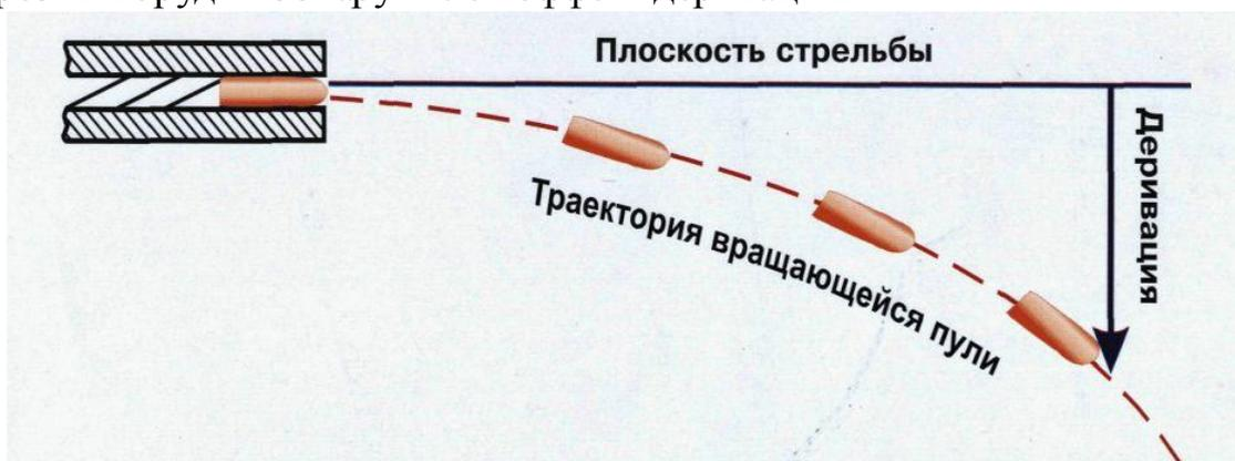
**Рис.11. Деривация – отклонение пули в горизонтальной плоскости**
