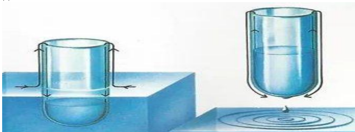
Рис.2. Жидкий гелий поднимается плёнкой по стенкам
