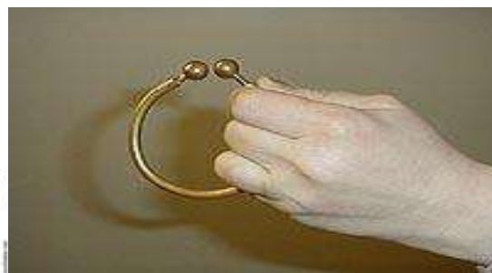
Рисунок 5-3. Слева - модификация вибратора Герца, справа – резонатор Герца
