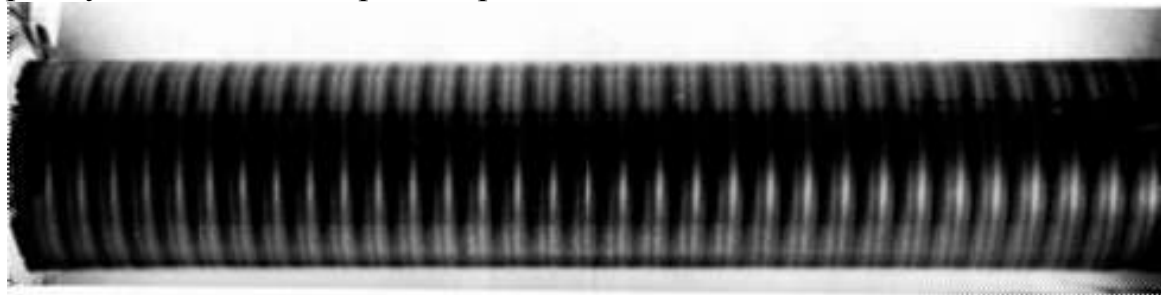
Рисунок 6-11. Генератор тороидальных вихрей на основе вращающегося цилиндра. (Ван-Дайк М. - Альбом течений жидкости и газа, фото 127)
