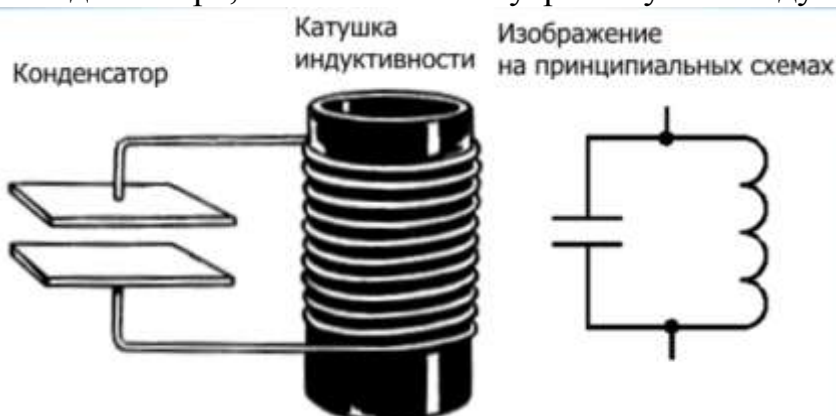
Рисунок 3-3. Электромагнитный замкнутый колебательный контур LC
