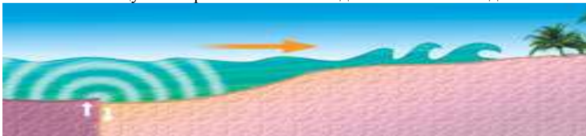
Рисунок 6-4. Возникновение цунами от сейсмического толчка
