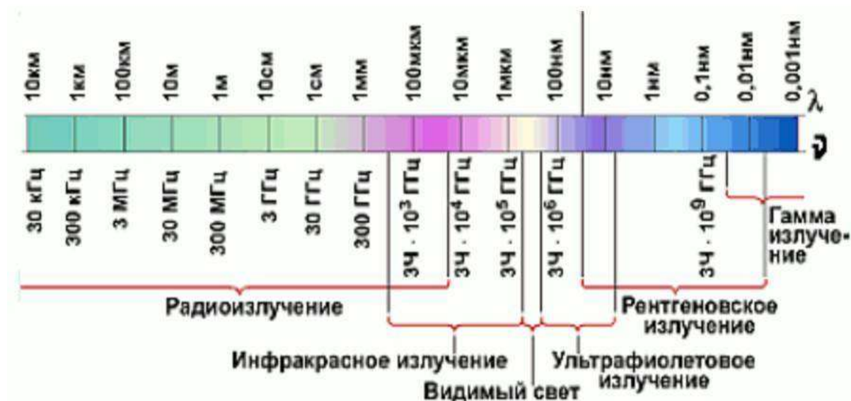
Рисунок 2-2. Шкала электромагнитных волн
