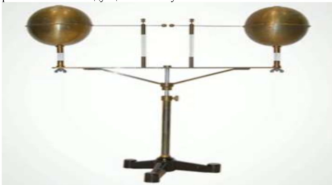
Рисунок 4-3. Внешний вид модификации вибратора Герца
