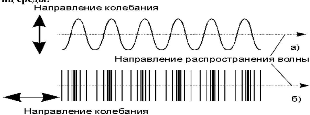
Рисунок 1-8. Поперечные волны (а) и продольные волны (б)
