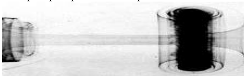
Рисунок 6-8. Генератор простых вихревых колец на основе трубки. (Ван-Дайк М. - Альбом течений жидкости и газа, фото 112)
